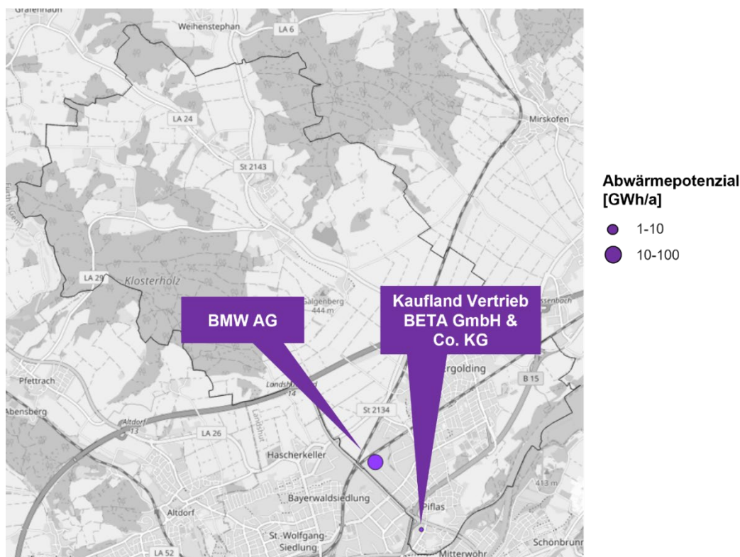
Abbildung 45: Potenzial für unvermeidbare Abwärme
