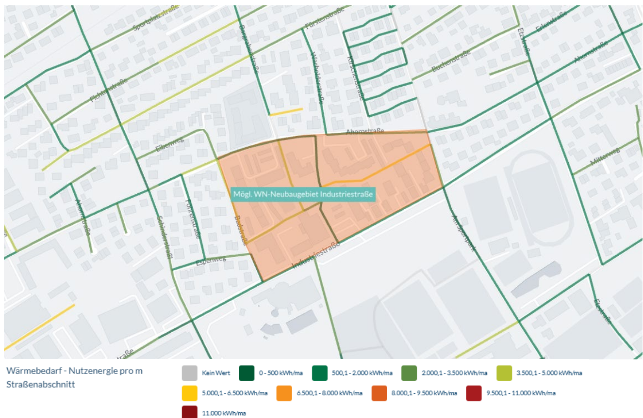
Abbildung 71: Fokusgebiet 1 (orange) – WN-Neubaugebiet - Wärmelinienindichten
