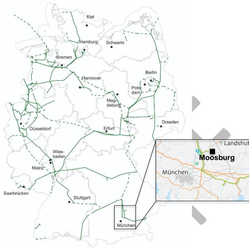
Abb. 30: Das geplante Wasserstoff-Kernnetz in Deutschland im Jahr 2032<sup>4</sup>
